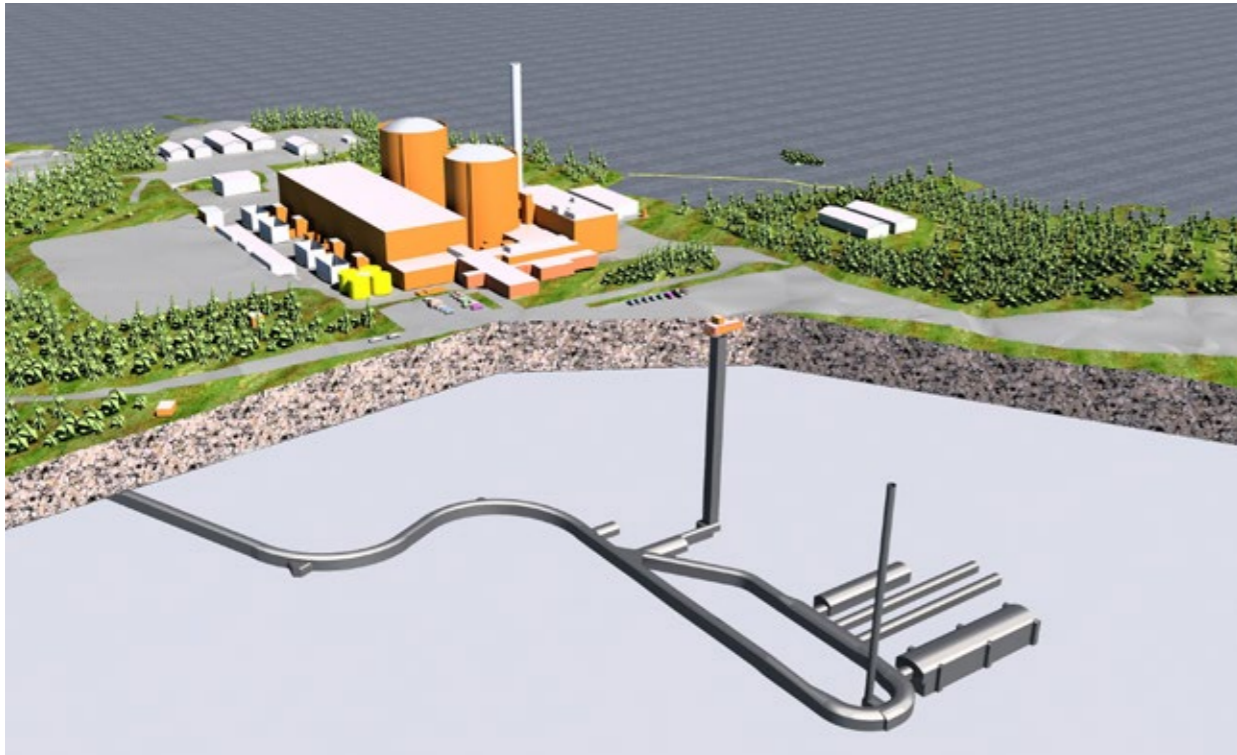
Kuva 3-4. Loviisan matala- ja keskiaktiivisen jätteen loppusijoituslaitos (VLJ-luola) tällä hetkellä.
